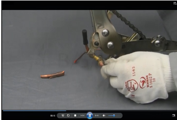
8.1.16 Verbinden des T-Stücks mit Schrader-Ventil
